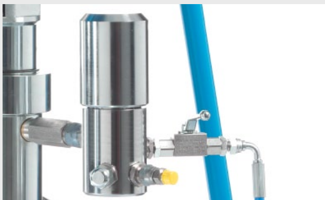
Estándar filtro Airless de alta presión en la salida de la bomba
