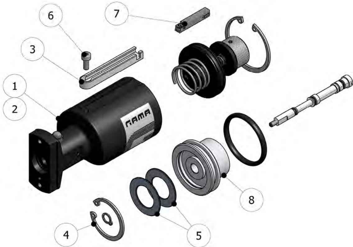
Figura 6. Ensamblaje Micro Magnético (OPCIONAL)
